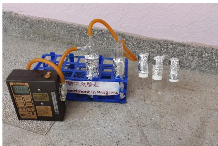
圖四：同步使用主動式(恆流量的抽氣泵)和被動式的採樣方法來設定後者的氣體通量
