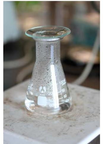
圖二:合成 13 nm 金納米粒子的裝置
