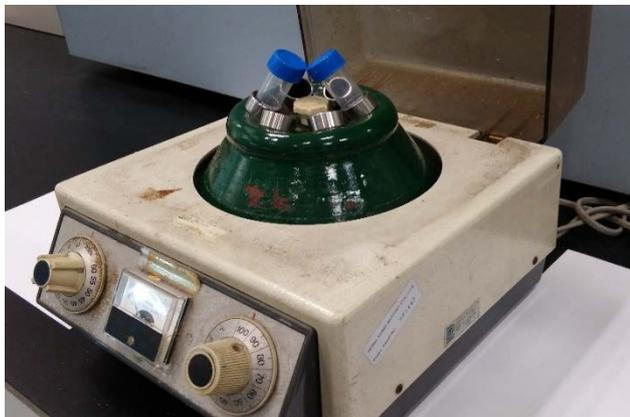
圖三. 離心管應水平設置在離心機裡，確保質量相同
