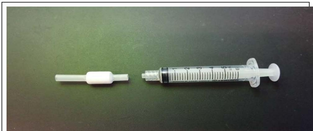
如實驗室不具備<多通道抽真空>的設備,可使用用完即棄的塑膠針筒,先將左端 SPE 管用溶液沖洗,然後再利用針筒加壓將樣品所得的水層壓過 SPE 管,以進行以下 C 部的檢測。
