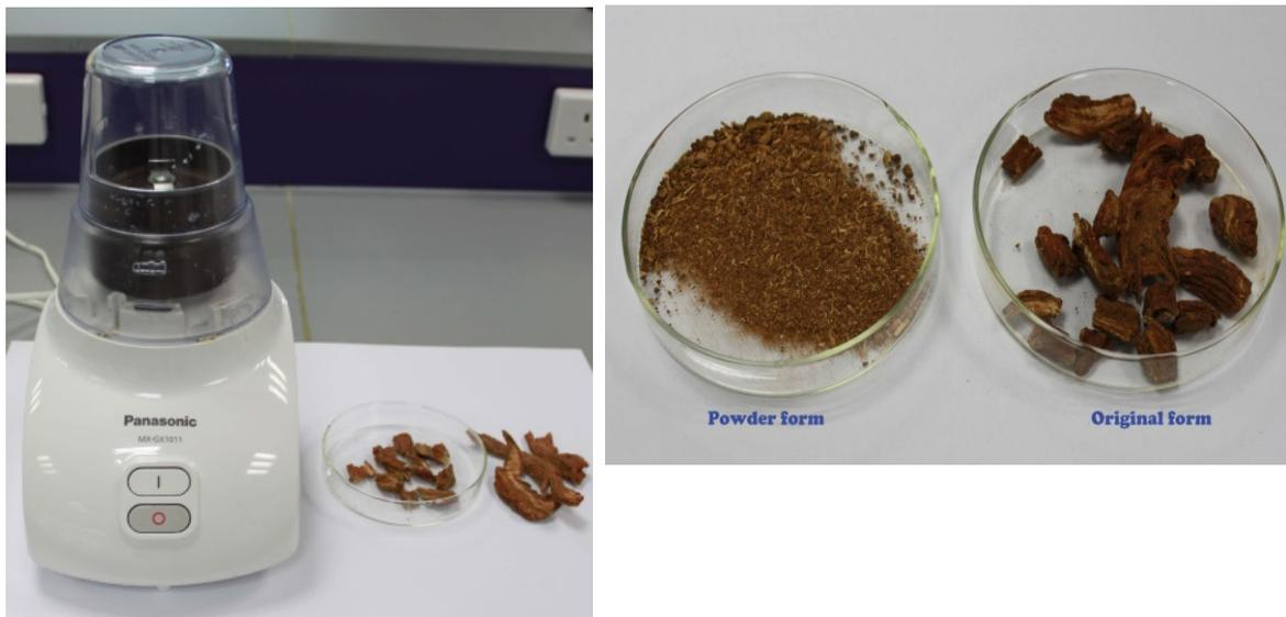
圖二：用攪拌機來將固體樣品砸碎成細粉
