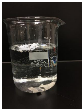
圖 9. 將氯化鈉溶液加入混合塑料物中
