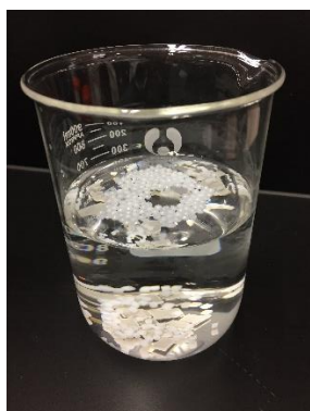
圖 7. 將去離子水加入塑料混合物中
