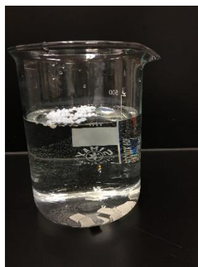
圖 10. 從混合物中分離/隔離 PS
